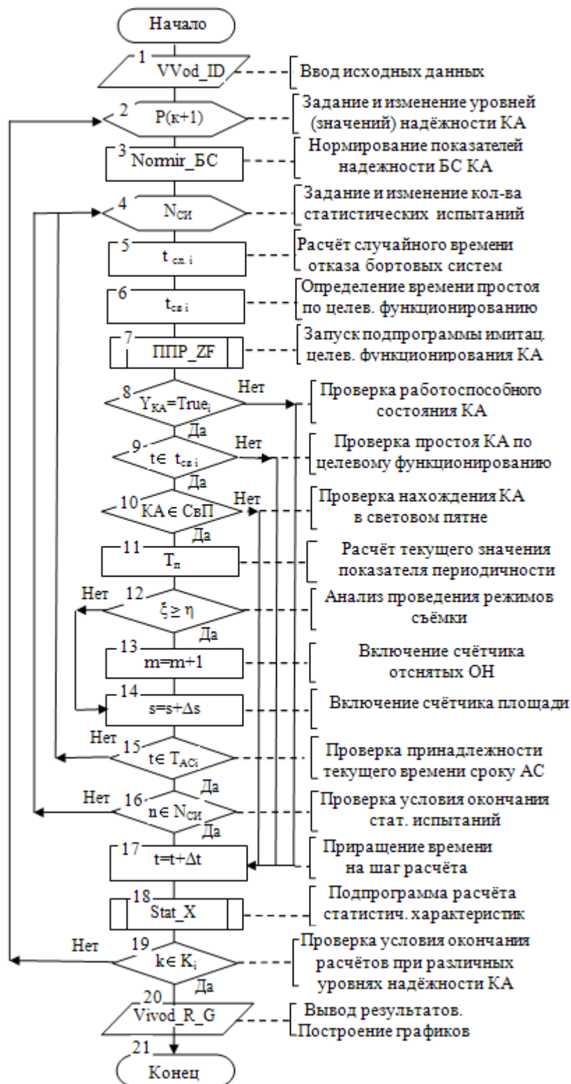
Рис. 5. Блок-схема алгоритма имитационного моделирования
