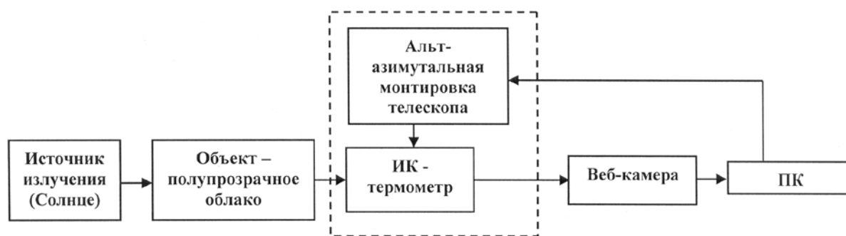
Рисунок 1 - Структурная схема следящей ИК-системы
