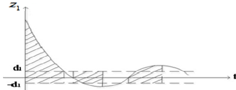
Рис. 3. График переходного процесса изменения ошибки приближения к точке A при продольном движении
