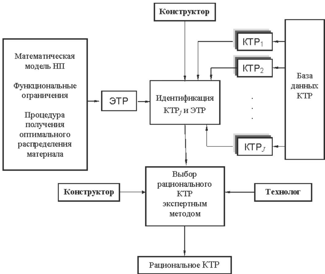
Рис. 1. Схема решения задачи структурно-параметрической оптимизации конструкции НП
