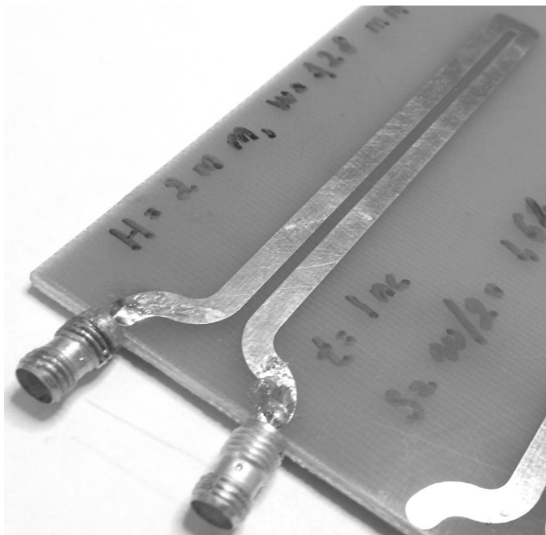
Рис. 4. Фрагмент печатной платы с макетами витков меандровых линий
