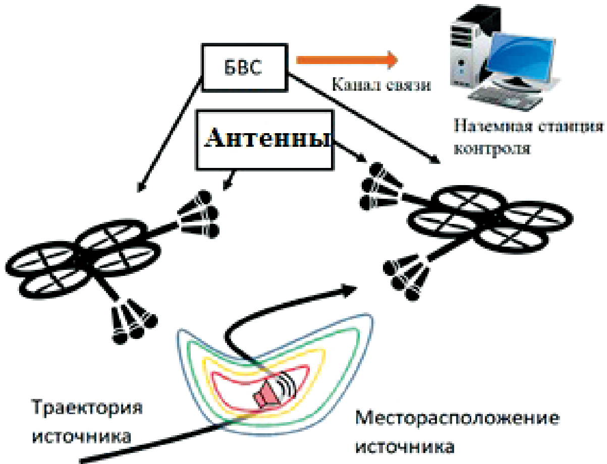
Рис. 2. Схема локализации БВС при помощи микрофонных антенн, устанавливаемых на БВС
