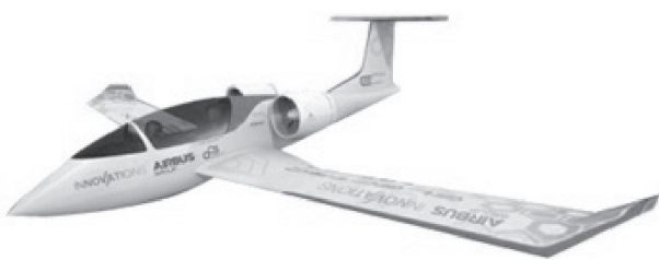
Рис. 3. Демонстратор технологии полностью электрического самолета концерна EADS пилотажный самолет E-Fan
