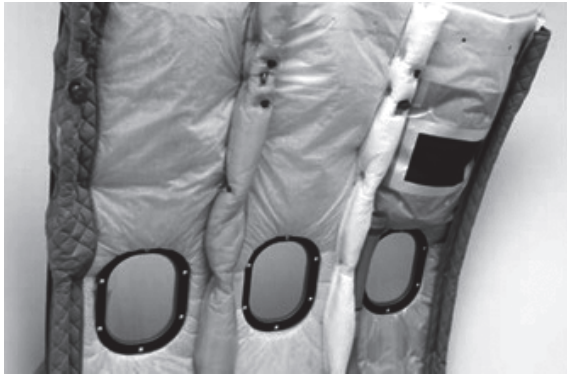
Рис. 7. Пример выполнения дифференцированной по отсекам теплозвукоизоляции
