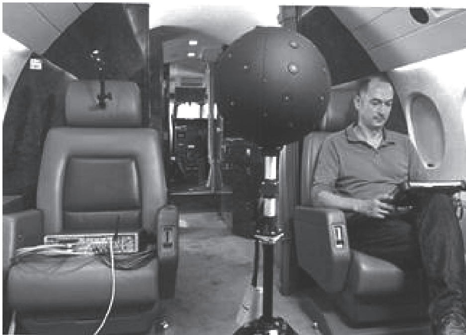
Рис. 5. Применение сферической микрофонной решетки для исследования структуры звукового поля в салоне самолета с помощью методов сферического бимформинга [31]
