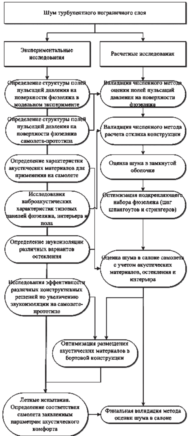
Рис. 4. Структура проблемы шума турбулентного пограничного слоя при проектировании гражданского самолета
