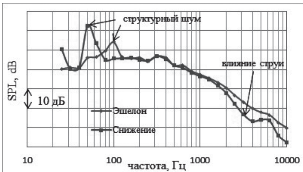
Рис. 2. Влияние дросселирования двигателя на 1/3-октавные спектры уровней звукового давления в хвостовой части салона самолета SSJ-100 с VIP-интерьером
