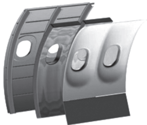
Рис. 6. Традиционная двустенная конструкция фюзеляжа самолета
