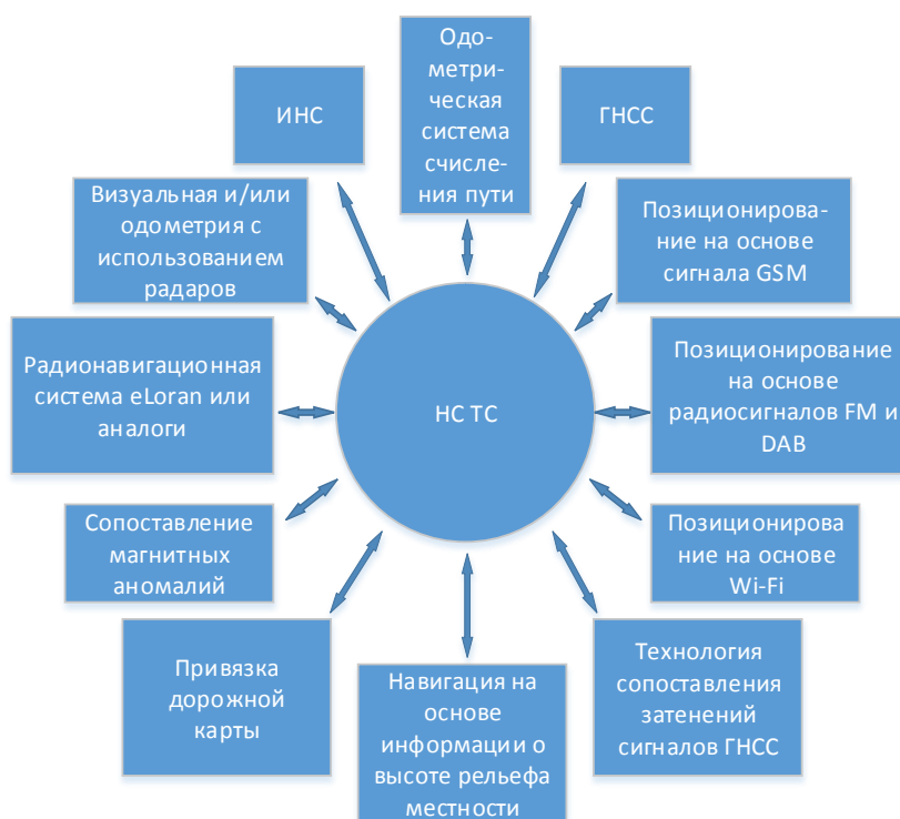
Рисунок 2 – Потенциальные компоненты навигационной системы ТС, использующей общедоступное оборудование и датчики с низкой себестоимостью
