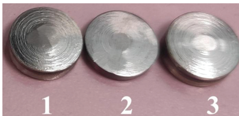
Рис. 12. Наружные контрольные образцы из стали X18H10T после испытаний на втором зачетном этапе экспериментов
