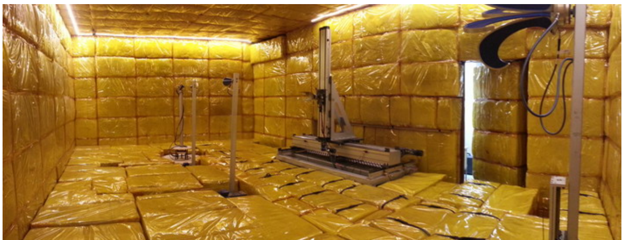
Рисунок 4.40 – БЭЖ с планарным сканером
