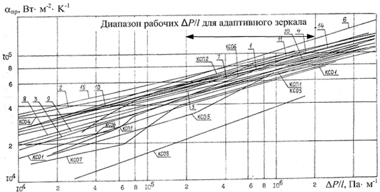
Рис. 6. Сопоставление систем охлаждения по энергетической эффективности. Кривые соответствуют: KCO1–KCO8 – каналные системы охлаждения [9]; KCP1, KCP2 – каналные системы охлаждения с прерывистой стенкой (подрезами) [4]; 1–20 – вафельные системы охлаждения [5–7]
