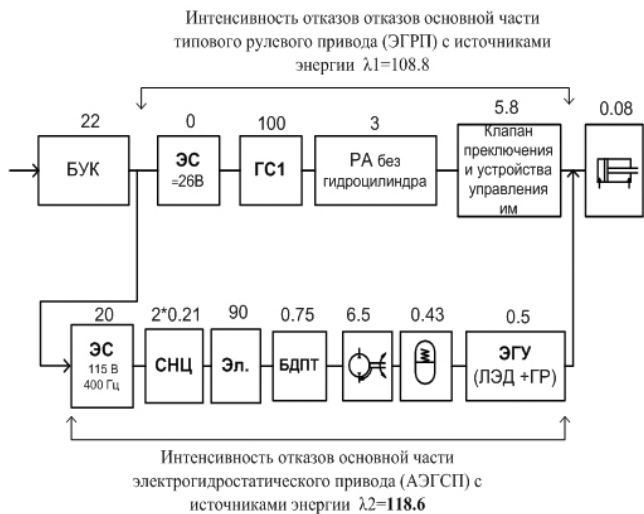
Рис. 9. Логическая схема оценки безотказности каналов комбинированного привода: ЭС — электросистема; СНЦ — устройства подключения электрики; ЛЭД — линейный электродвигатель; ГР — гидрораспределитель (над блоками указаны приближённые оценки интенсивности их отказов \lambda , умноженные на 10^6 )
