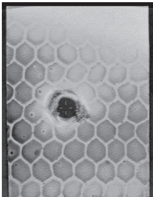
Рис. 16. Томограмма повреждения сотового заполнителя лопасти со стороны верхней обшивки в продольном (а) и поперечном (б) сечениях
