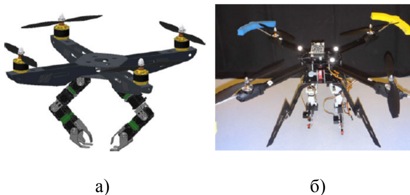
Рис. 5 – Прототип второго поколения БЛМ [16]: а) конструкторская модель; б) прототип
