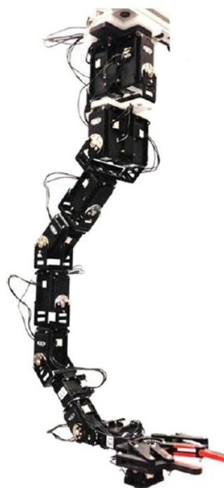
Рис. 6 – Многозвенный манипулятор для БЛА [13]
