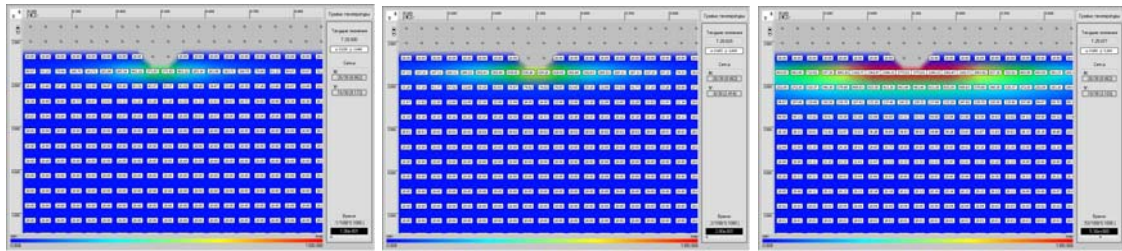
Рис. 4. Модельный расчет динамики изменения температуры при лазерном нагреве.
