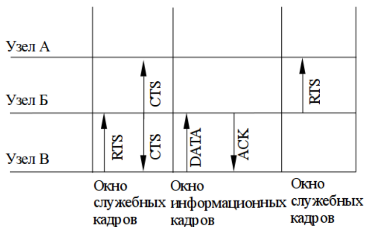
Рисунок 3 – Принцип работы алгоритма доступа к среде LCM MAC
