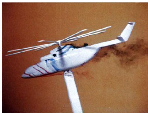
Рис. 8. Структура обтекания модели вертолета Ми-26 с работающим несущим винтом при \alpha=-15^\circ , \beta=-10^\circ , \mu=0.15
