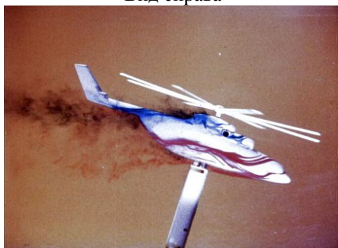
Рис. 10. Спектры обтекания модели вертолета Ми-26 при \alpha=15^\circ , \beta=0 , \mu=0.24
