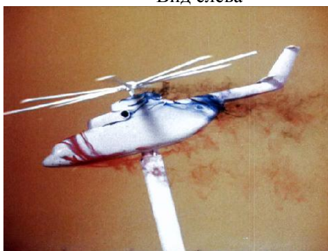
Рис. 9. Визуализация структуры обтекания модели вертолета Ми-26 с работающим несущим винтом при \alpha=-15^\circ , \beta=10^\circ , \mu=0.15
