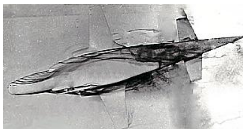
Рис. 4. Вид снизу на структуру обтекания модели планера вертолета Ка-50 при \alpha=-10^\circ , \beta=-10^\circ
