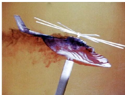
Рис. 8. Структура обтекания модели вертолета Ми-26 с работающим несущим винтом при \alpha=-15^\circ , \beta=-10^\circ , \mu=0.15
