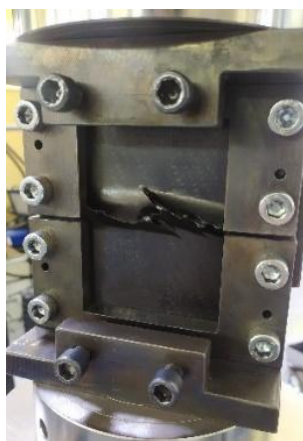
Рисунок 8 – Вид разрушенного образца во время испытаний
