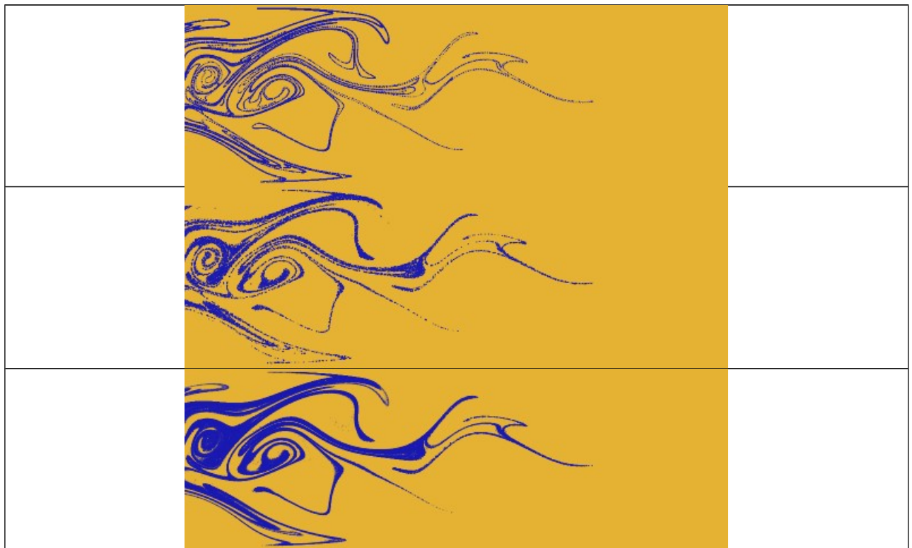
Рис.6. Сравнение картин перемешивания на выходе из проточного тракта, полученных разными методами (контурный, маркерный, дипольный).
