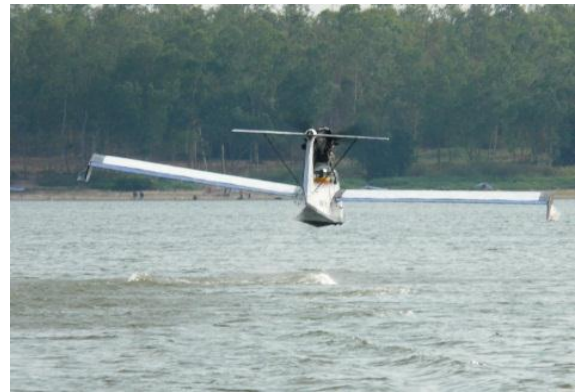
Рис.48. Испытания гидросамолета с обратно вертикальными законцовками крыла и поплавками (крыло L0.25).
