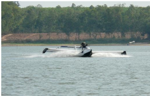
Рис.48. Испытания гидросамолета с обратно вертикальными законцовками крыла и поплавками (крыло L0.25).
