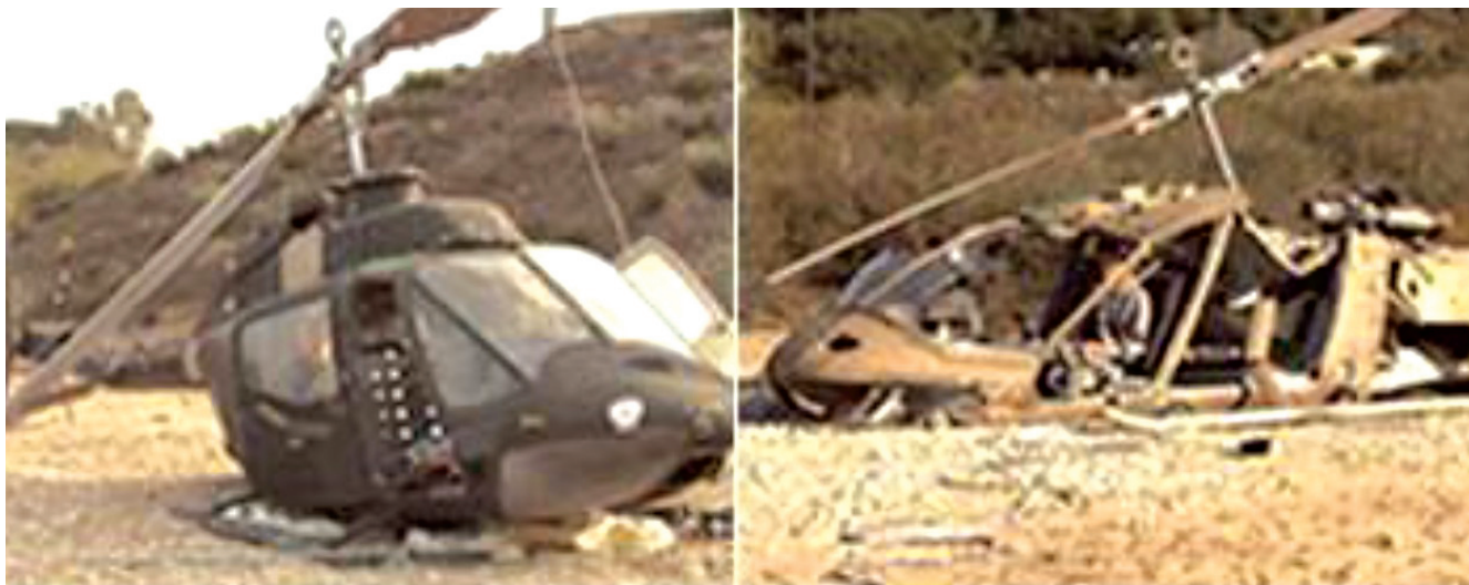
Рис. 12. Результаты испытаний без внешних подушек (справа) с внешними подушками (слева)
