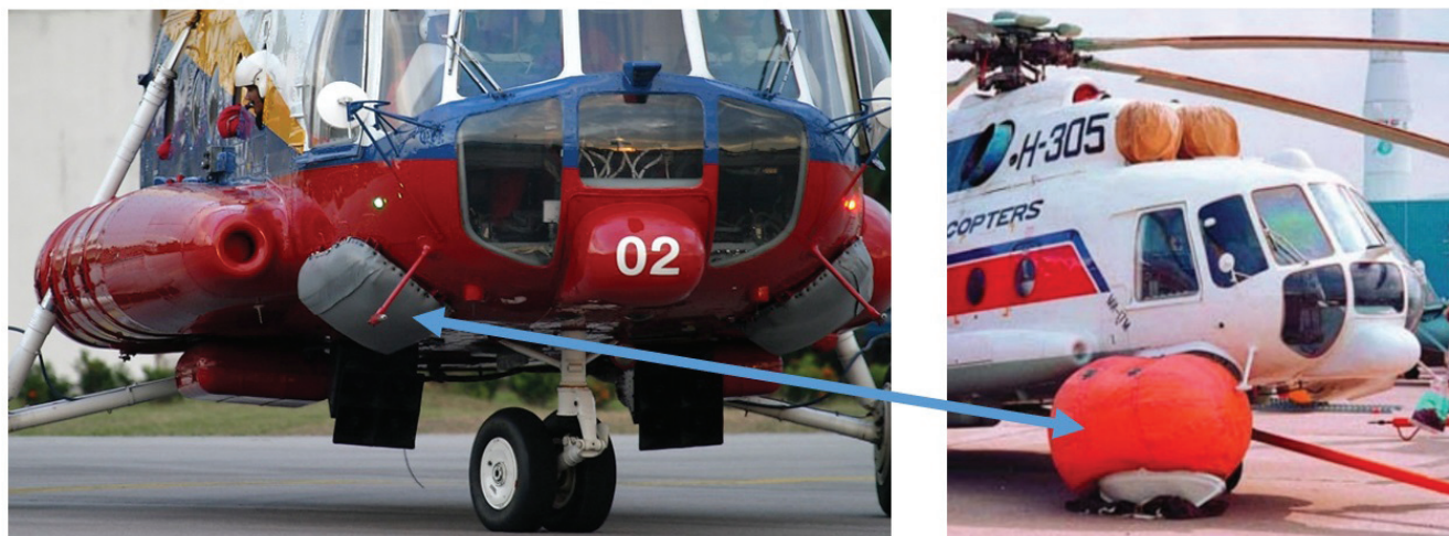
Рис. 16. Упакованное и развернутое состояние баллонов на фюзеляже
