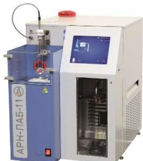
Рис. 2. Прибор для построения кривых дистилляции APH – ЛАБ – 11
