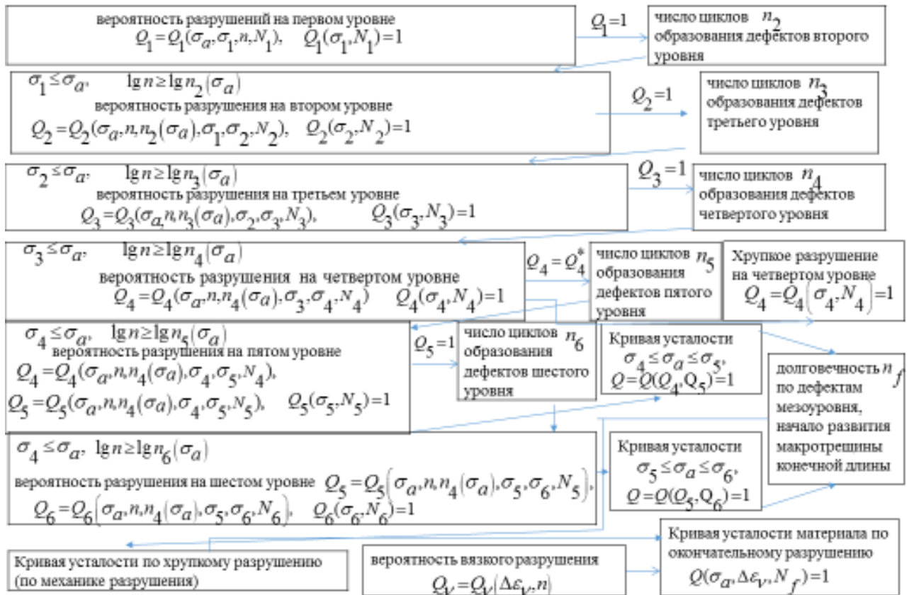
Рис. 2.3 Блок-схема алгоритма расчета по модели усталостного разрушения металлов при одноосном нагружении
