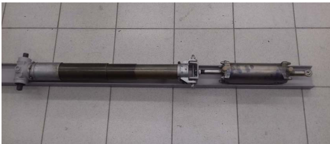
Рис. 6. Настраиваемый резонатор Гельмгольца
