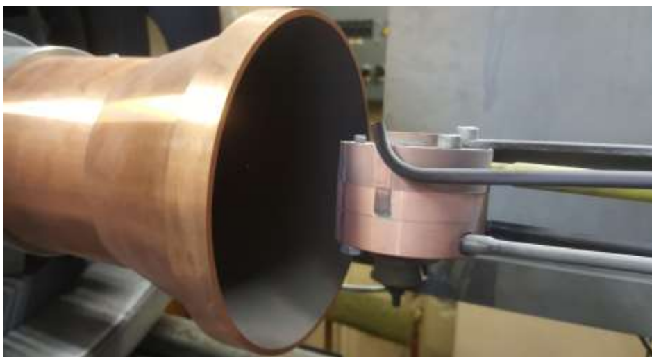
Рисунок 7.5 - Плазмотрон и макет с нанесенным покрытием в рабочей камере плазменной установки.
