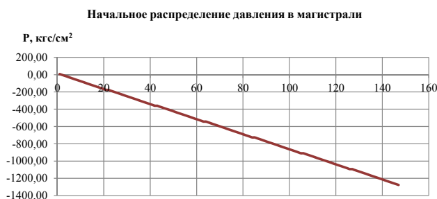
Рис. 8. Распределение начального давления в соответствии с гидравлическими характеристиками магистрали
