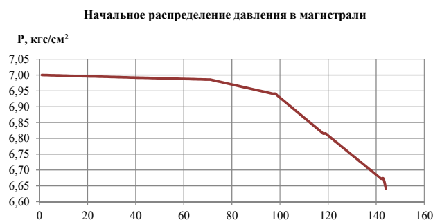
Рис. 7. Распределение начального давления в соответствии с гидравлическими характеристиками магистрали
