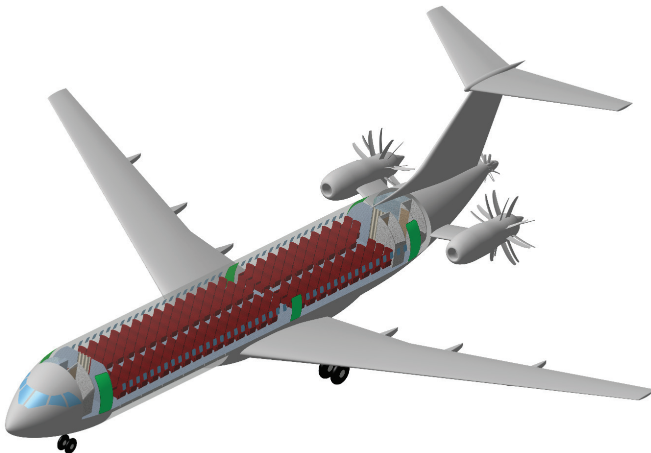
Рис. 5. Полученная с помощью АВТОКОМ геометрия внешних обводов и внутренней компоновки магистрального самолёта
