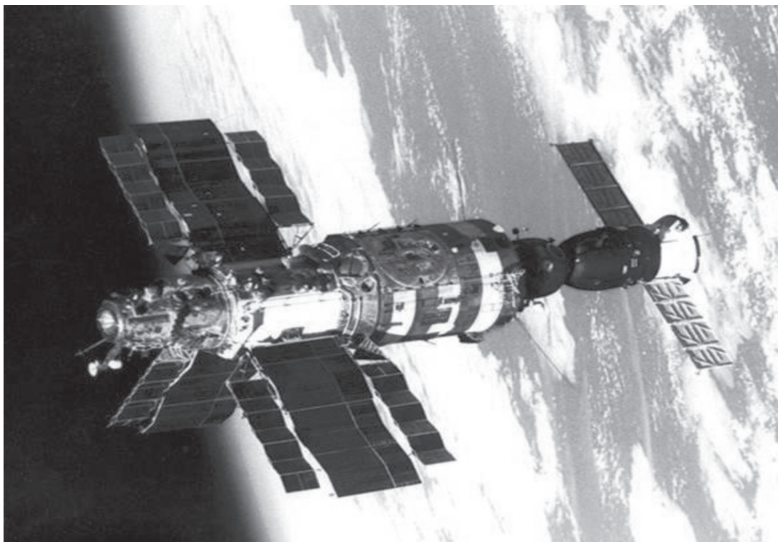
Рис. 3. Долговременная орбитальная станция «Салют-7» с установленными дополнительными солнечными батареями и пристыкованным к агрегатному отсеку транспортным пилотируемым кораблем «Союз»
