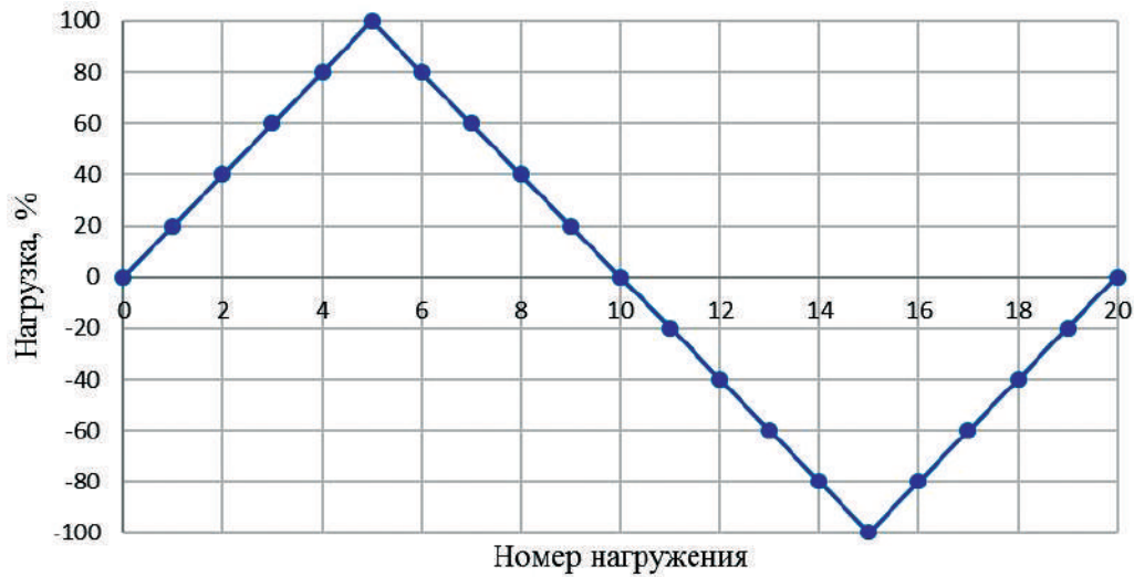
Рис. 3. Схема калибровки для одного компонента тензосесов
