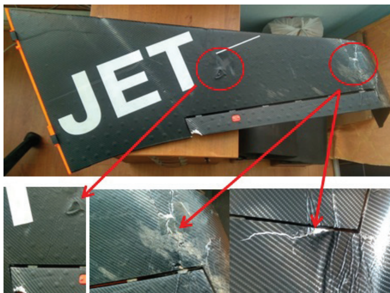
Рис. 1. Крыло БПЛА из пенопласта после полета
