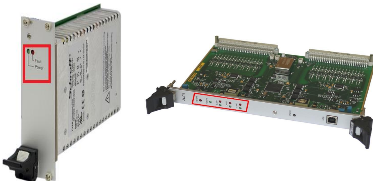
Рис. 1. Источник питания и блок аналого-цифрового преобразователя
