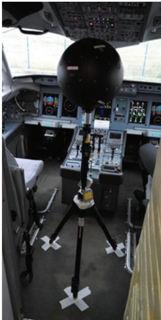
Рис. 1. Сферическая микрофонная решетка Simcenter Solid Sphere 3DCAM54 в базовой конфигурации (54 микрофона)
