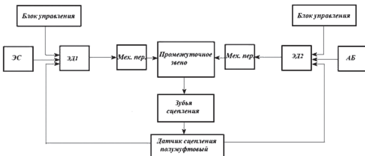
Рис. 6. Функциональная блок-схема резервированной муфты сцепления-расцепления валов: ЭС — энергосеть основная; АБ — аккумуляторная батарея; ЭД — электродвигатели; Мех. пер. — механическая передача; Промежуточное звено — сцепление полумуфт
