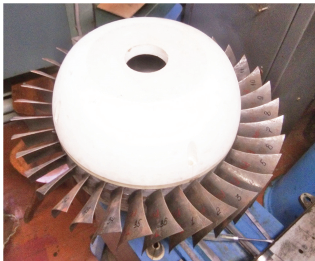
Рис. 7. Общий вид опытной модели рабочего колеса вентилятора
