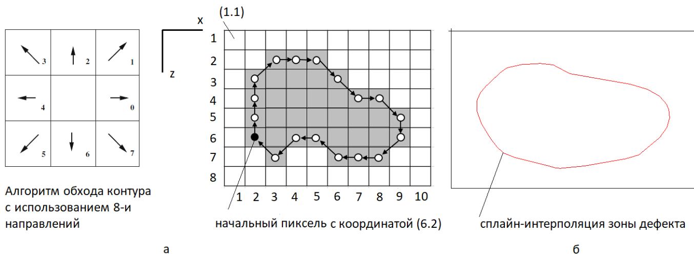
Рис. 6 - Построение контура зоны дефекта
