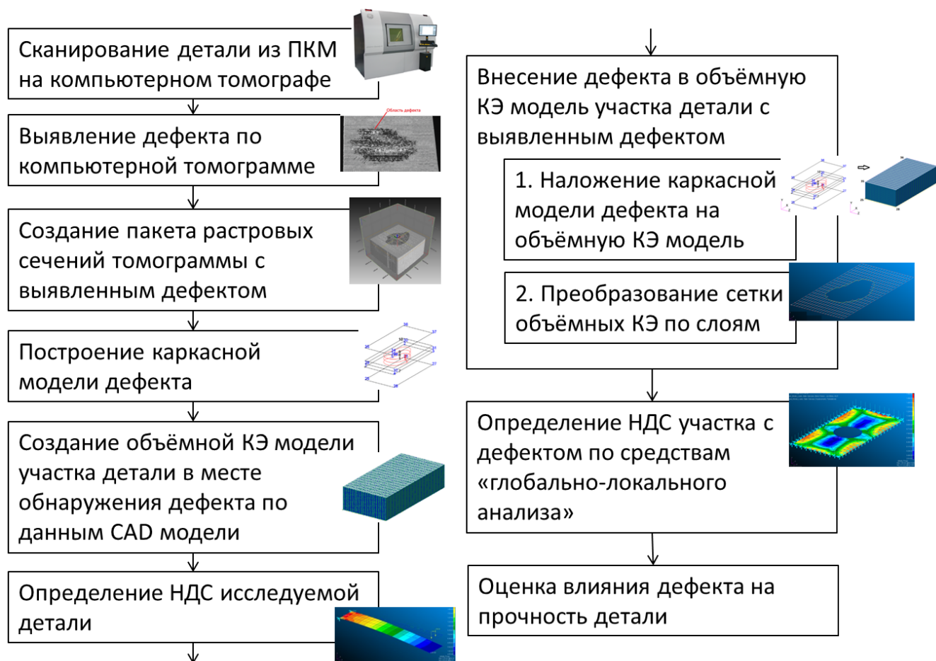
Рис. 4 - Блок-схема алгоритма построения КЭ модели слоистого композиционного материала
