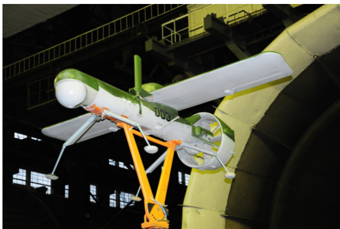
Рисунок 2 – Схема размещения БПЛА в рабочей части АДТ Т-104
