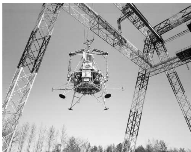
Рис. 2. Тросовая подвеска спускаемого аппарата летного стенда LLRF
