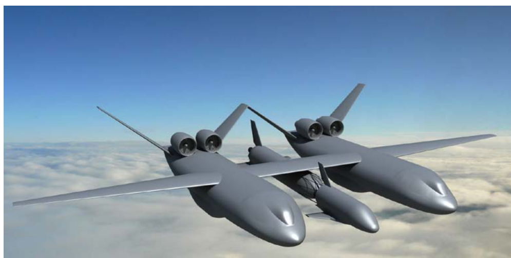
Рисунок 1 – Аэрокосмическая система на базе дозвукового двухфюзеляжного самолета-носителя
