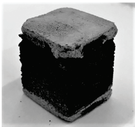
Рис. 7. Образец, подготовленный к тесту на сжатие [21]
