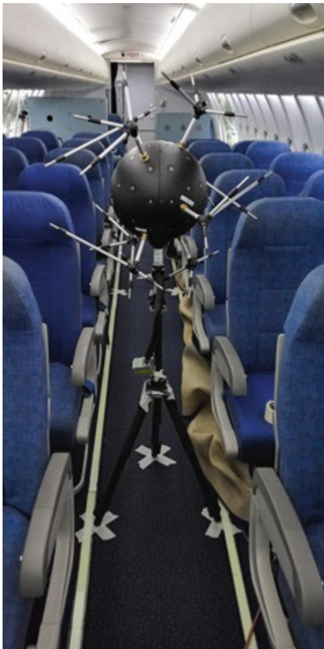
Рис. 1. Сферическая микрофонная решетка Simcenter Solid Sphere 3DCAM78 в расширенной конфигурации (78 микрофонов) в салоне экспериментального самолета
