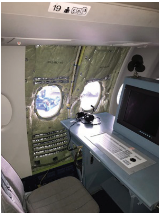
Рис. 8. Общий вид хвостовой части экспериментального самолета со стороны левого борта с отсутствующими панелями интерьера
