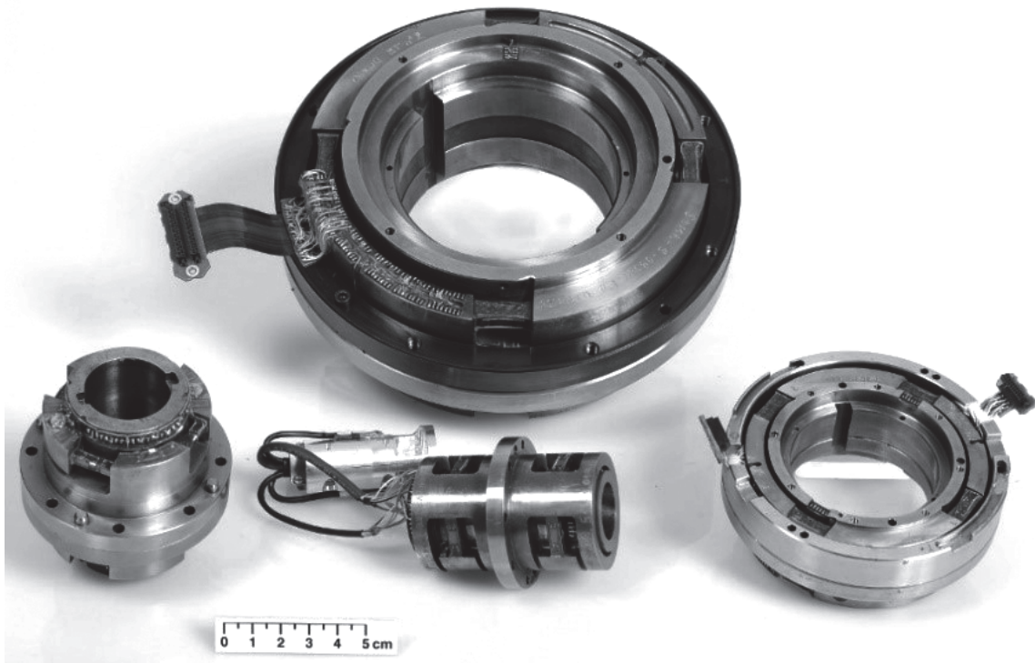
Рис. 3. Шестикомпонентные ВВ компании ONERA (Франция)
