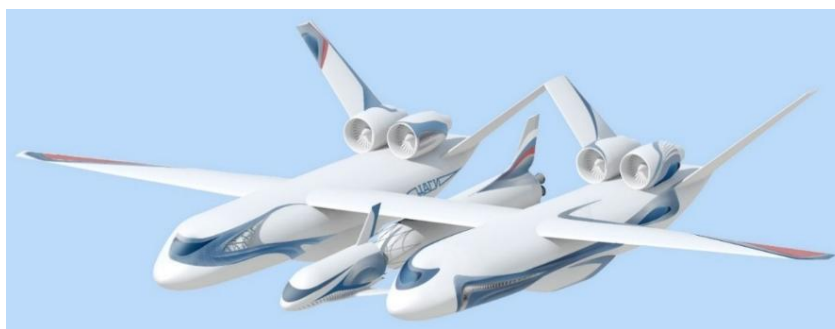
Рисунок 1 – Полностью многоразовая АКС на базе двухфюзеляжного самолета-носителя (один из вариантов самолета-носителя)
