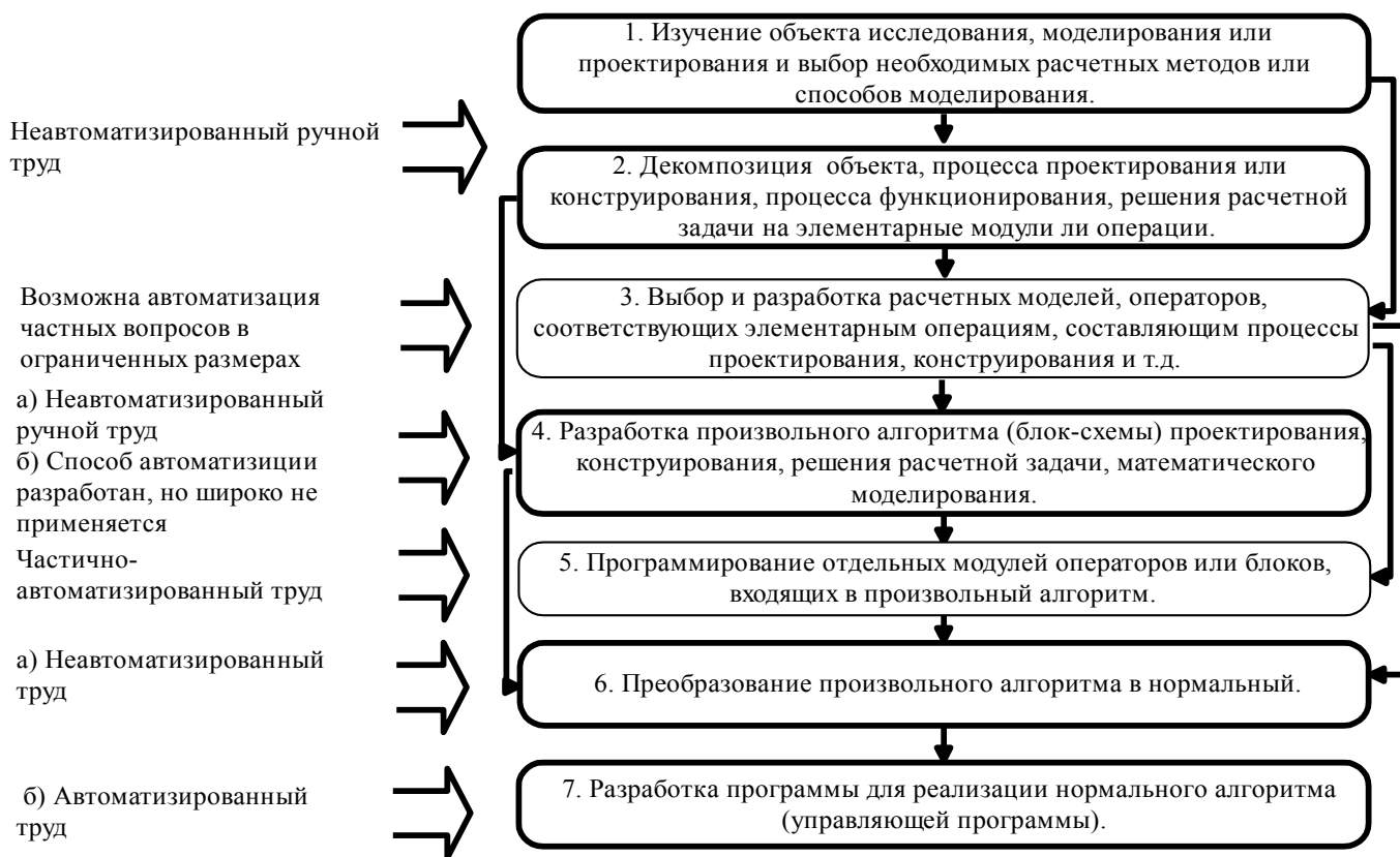
Рис. 1. Единая технологическая схема разработки МПО.
