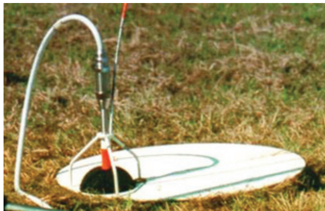
Рис. 1. Общий вид измерительного микрофона при выполнении сертификационных испытаний согласно требованиям Главы 10 стандарта ИКАО
