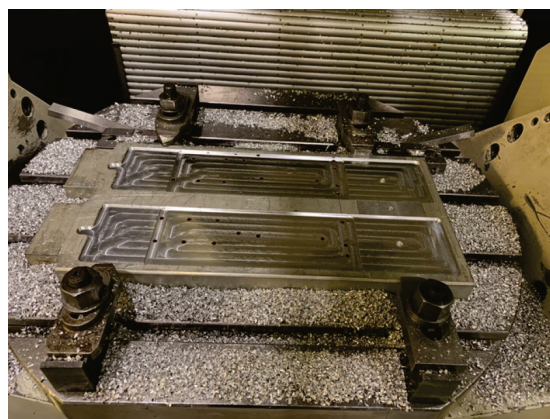
Рис. 2. Внешний вид одного из тепловых макетов в процессе механической (фрезерной) обработки
