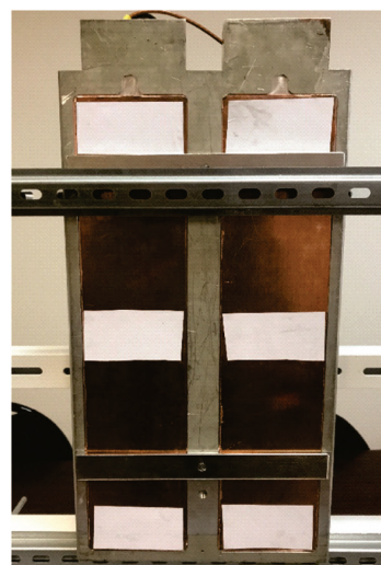
Рис. 11. Вариант конструкции 1 с внешним расположением медных оснований
