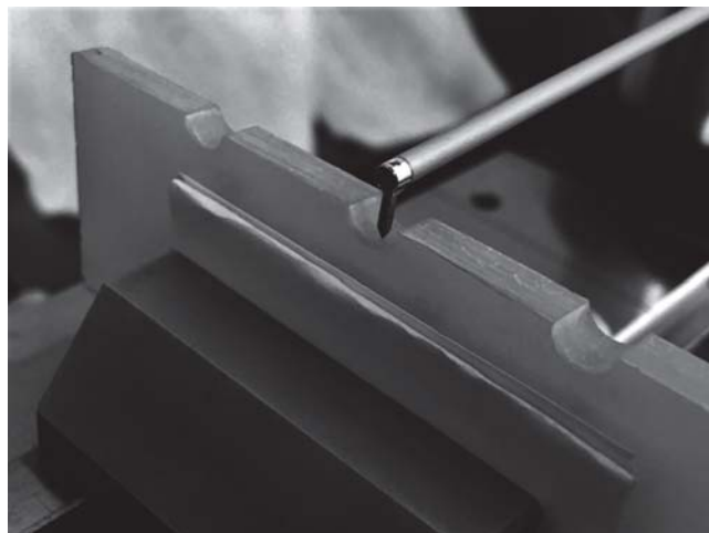
Рис. 8. Общий вид хода измерения шероховатости методом профилометрии
