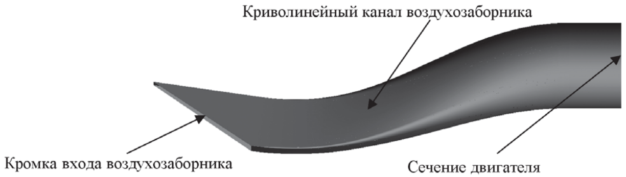
Рис. 1. Образ математической модели воздухозаборника без системы управления пограничным слоем
