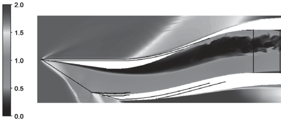
Рис. 10. Режим M_\infty = 1,8 , \alpha = 0 . Вариант воздухозаборника без системы управления пограничным слоем: а — зависимости параметра \epsilon от q(\lambda_{дв}) ; б — расчётное мгновенное поле чисел M в продольном сечении воздухозаборника при q(\lambda_{дв}) = 0,666 ; в — расчётное мгновенное поле коэффициента восстановления полного давления v на входе в двигатель при q(\lambda_{дв}) = 0,666
