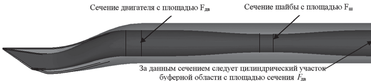
Рис. 6. Схема моделирования дросселирования канала воздухозаборника
