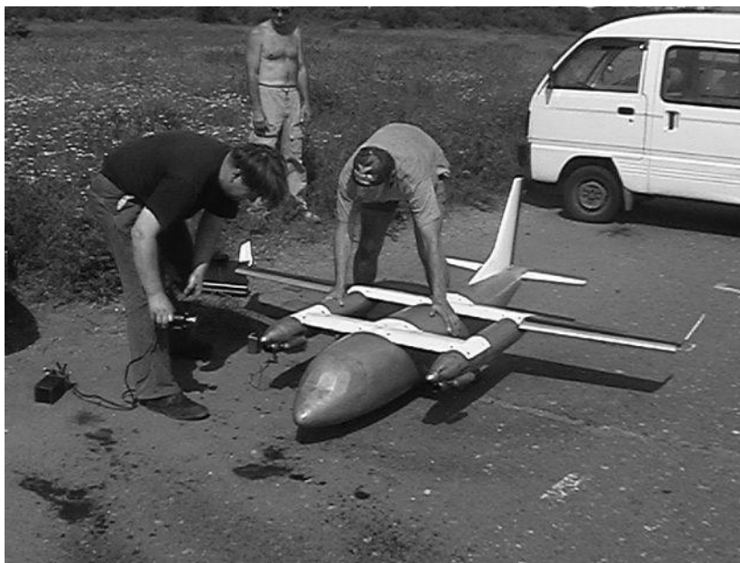
Рисунок 3 - Динамически подобная летающая модель самолета
