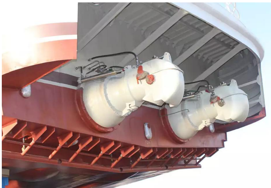
Рис. 1. Гидродинамические интерцепторы поворотного типа, установленные на кормовом срезе судна проекта А-145
